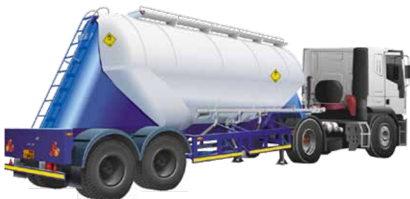
Рис. 3.2. Автоцистерна для сыпучих грузов
