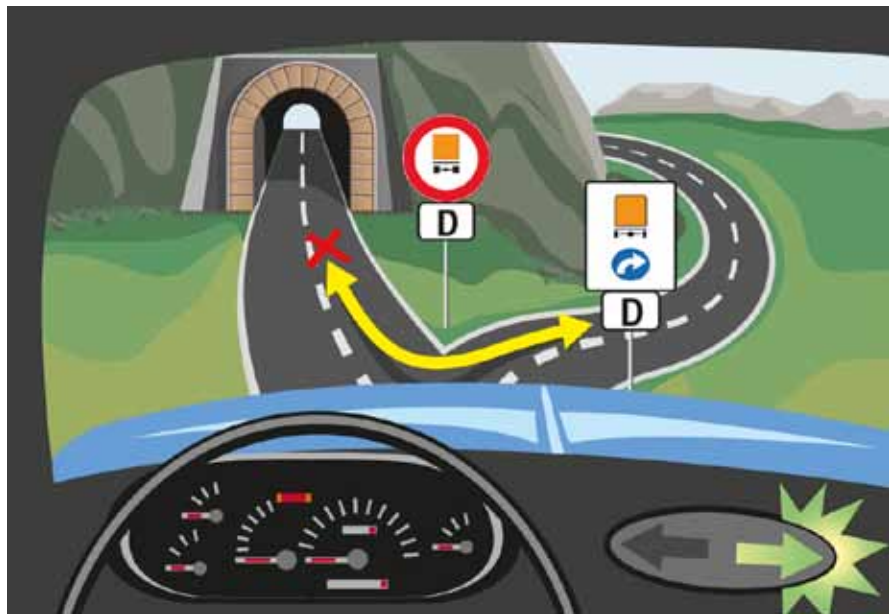
Рис. 6.19. Разрешенное направление движения для автоцистерны, перевозящей опасные грузы UN 1203 Бензин моторный и UN 1202 Топливо дизельное
