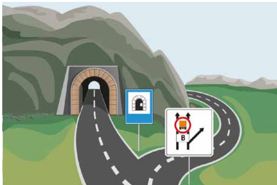
Рис. 6.16. Пример установки дорожного знака определяющего категорию тоннеля
