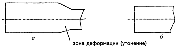
Рис. 153. Разрушение детали при различных видах деформации: а — разрушение с пластической деформацией; б — разрушение по концентратору напряжений
