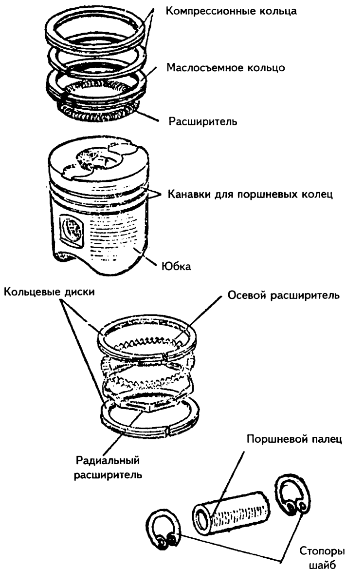
Рис. 5. Детали поршневой группы двигателя
